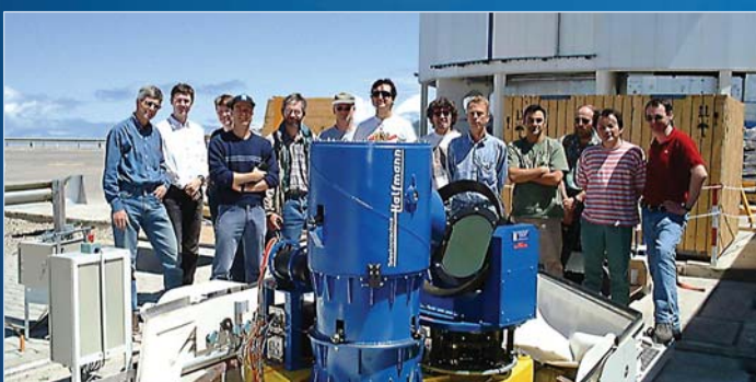
Der Spiegel vom Halfmann-Siderostat der Europäischen Sternwarte in Nordchile wird vom Netzteil VM260/60 hochgenau positioniert.
