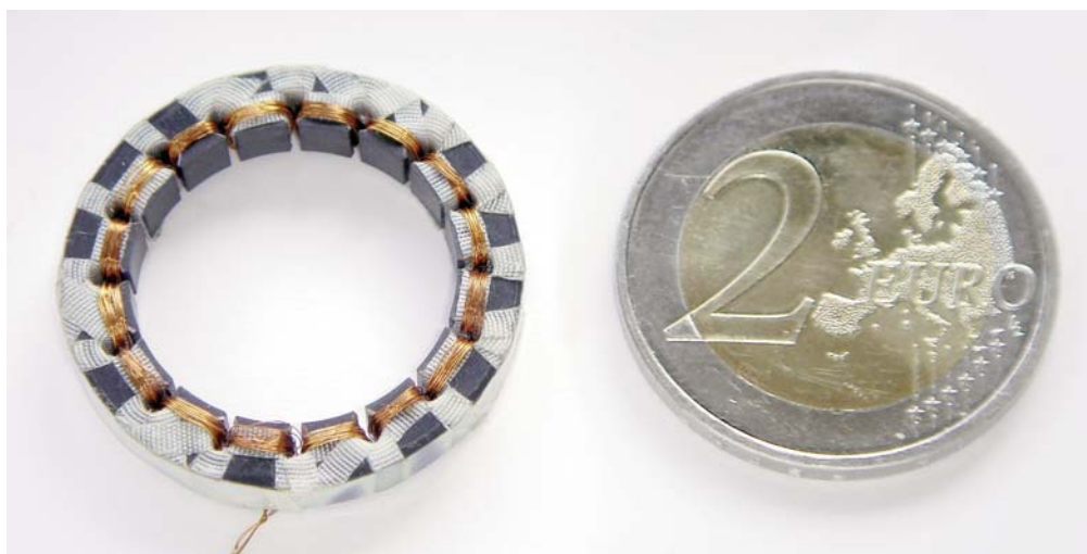
Prüfaufbau an einem HF-Lagegeber für einen hochdynamischen BL-DC-Motor
