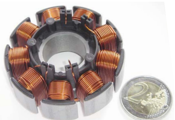
Außenläufer - Vollautomatisch gewickelter Stator
