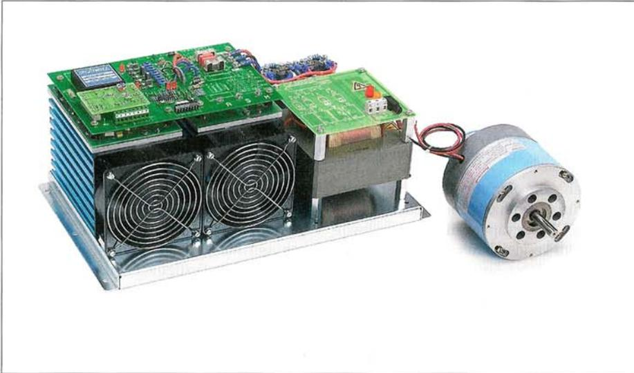
1: Servoverstärker mit Linearendstufe des Typs DCP520/60B mit Glockenankermotor vom Typ 55NM81-120-1
