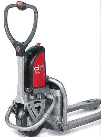
Das große Antriebsrad ist aus einer Art Vollgummi, die beiden hinteren Lastrollen sind schwenkbar gelagert und passen sich allen Hindernissen an. Auch Rampen von bis zu acht Prozent Steigung lassen sich ohne Kraftanstrengung meistern.
